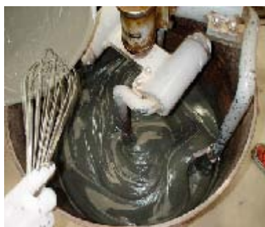
写真-1 ソイルミキサーによる供試体作製の様子
