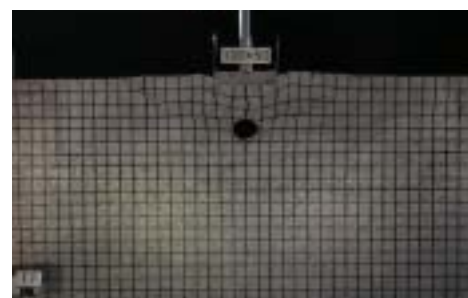
写真-1 観察された変形メカニズム （軟らかい紙： H/D=1.5 , L=100 mm, S/L=0.11 )
