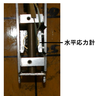
図-2 模型杭先端部写真
