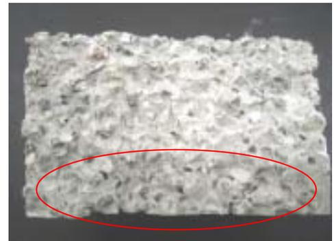
写真3 強度の規定を満たしている供試体の曲げ破壊断面
