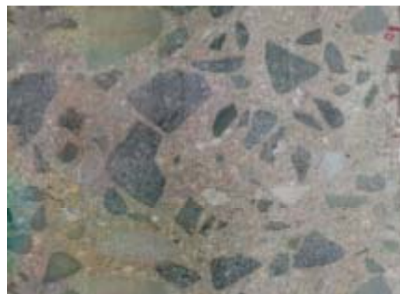
写真-5 試作ビットで穿孔した孔壁面の画像
