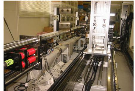
図-1 配筋ロボット (2号機)
