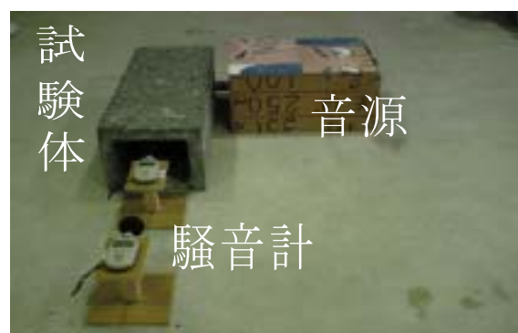
写真-1 箱型コンクリートを利用した音の測定
