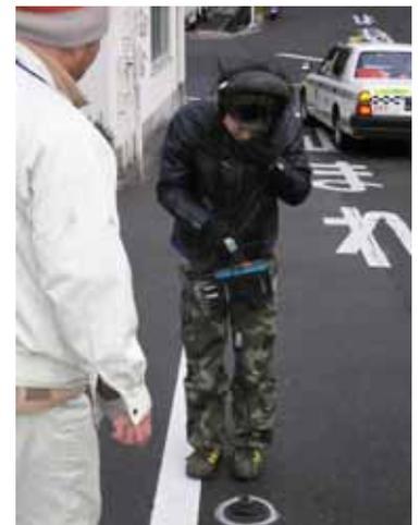
図 - 2 漏水調査の例
