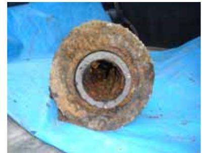
図 - 1 腐食が見られる経年管
