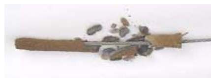
写真-1 グラウト部の逐次破壊(引張型)
