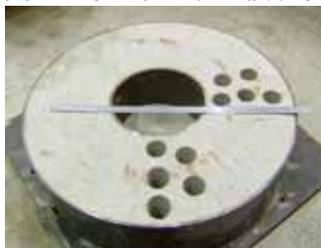
図6 転圧試験体とコア採取位置
