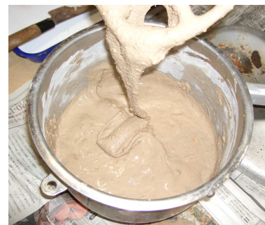
写真-1 5秒間攪拌した試料
