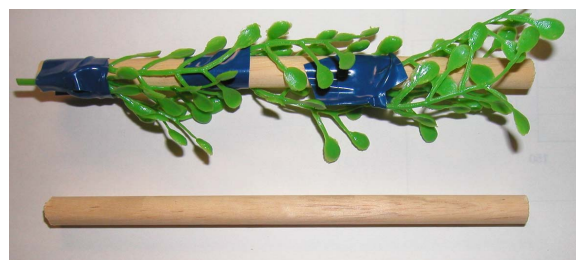
写真-1 実験に用いた流木模型( L=13.5\text{cm} )
