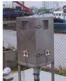
写真1 飛来塩分量測定試験
