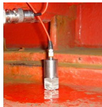
図-6 加速度計設置状況
