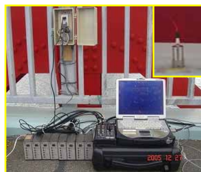
写真-2 常時微動計測システム
