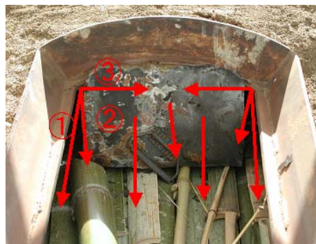
図4 窯内部における伝熱経路の概略図(実験2)
