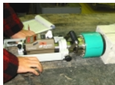
写真-1 水平打撃方向のテストアンビル
