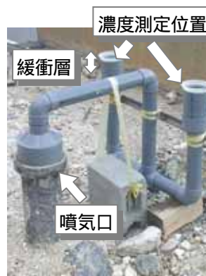
図1 H_2S 吸着実験装置 (現地)
