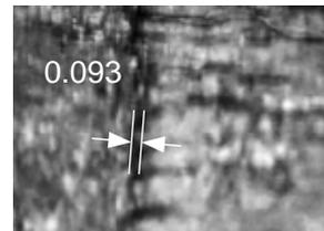
写真 - 1 実験前の亀裂
