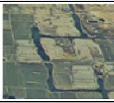
基本的にすべてのクリークは田畑と接している。繁忙期の水位は田の地盤高とほとんど変わらない。河川から取水した水を行き渡らせる幹線「流れ掘」と枝線によって構成される。貯水量を多くするために蛇行が設けられている。近年では圃場整備とともに直線化されたクリークが多く見られる。            |
