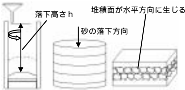
図-2 空中落下法による異方性の影響
