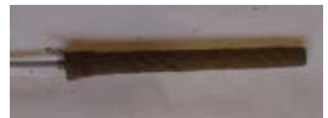
写真-3 圧縮型のグラウト部
