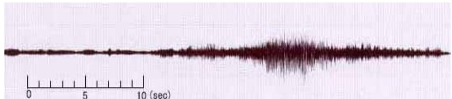
図-1 a. 地盤振動の波形 (Geophone, X=0m)
