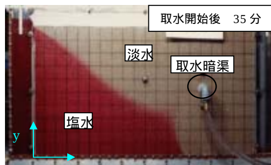
写真-1 取水による塩水侵入実験
