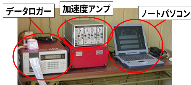
a) 計測システムの設置状況
