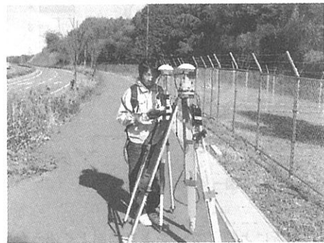
写真1 RTK-GPS観測(初期化)
