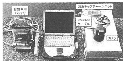
図-7 システム設置状況
