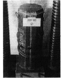
写真・2 試験後の供試体(SH-40)
