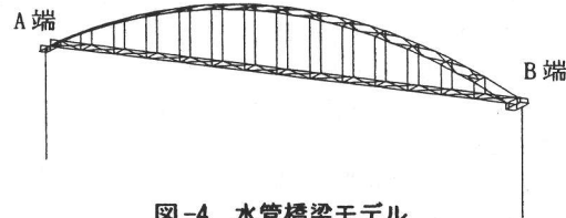
図-4 水管橋梁モデル
