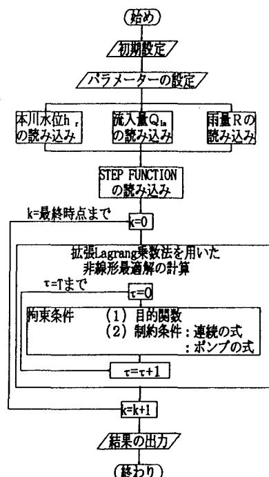
図-2 逐次最適制御のためのフローチャート
