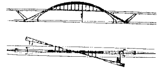
図 1 鋼クロスサポートアーチ橋
