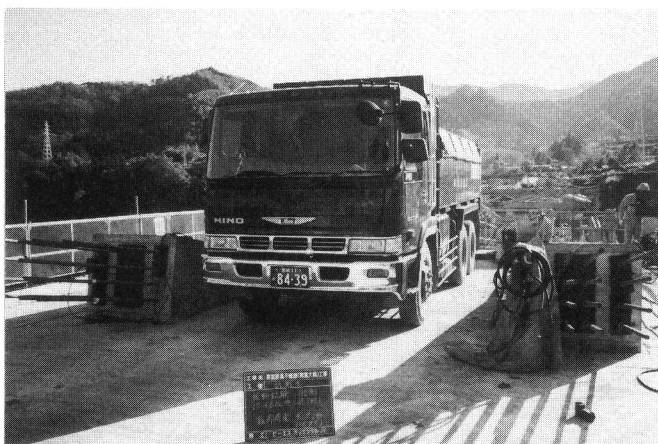
写真－1 振動試験状況
