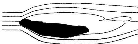
図6 可視化スケッチ(F30A. \alpha=+6^\circ .高欄無し)
