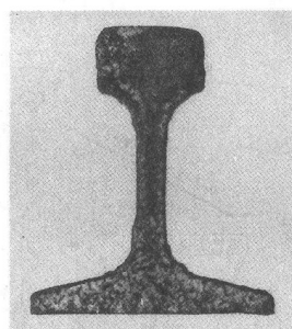
写真4 敷設5年のレール断面
