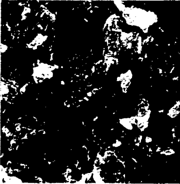
写真-1 有明粘土・不攪乱 水平断面
