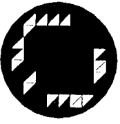
面に垂直な1 kg/cm²の等分布荷重を半球体全面に載荷した場合の主応力分布図 (白: 引張り, 黒: 圧縮)
