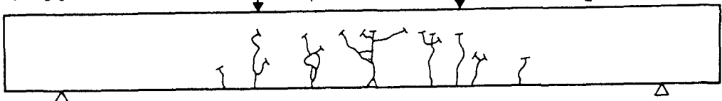
図-3 ひびわれ発生状況(T-1)
