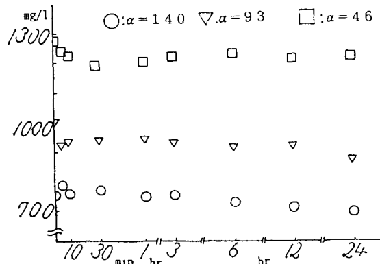
図-6 バッチ試験結果 10mmol/l \text{H}_2\text{SO}_4 ( \text{SO}_4^{2-} )
