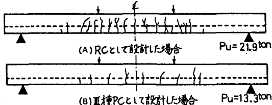
図-2 合成はりのひびわれ性状
