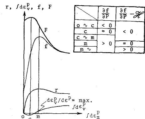
構成式(15)による連続的降伏、塑性移行過程および軟化現象の解釈
