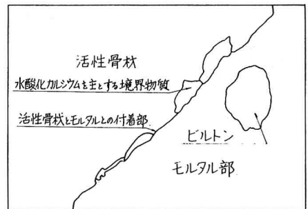
図6 活性骨材とモルタルとの付着状況
