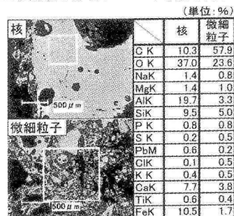
図-2 核及び微細粒子のSEM-EDX分析結果(×40)
