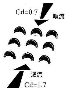
図2 流況制御ブロック
