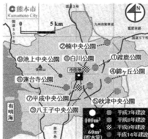
図 - 2 熊本市における貯水槽の設置状況
