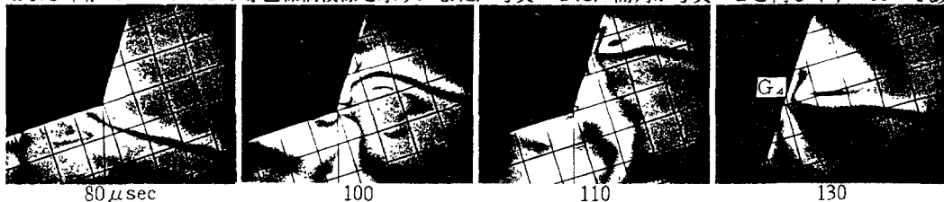
写真-1 模型M4 ( \phi=123.8^\circ )の等色線縞模様 \gamma_A=33.8^\circ, \gamma_B=90.0^\circ
