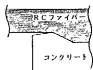
図3 2次元モデルでのき裂進展領域図
