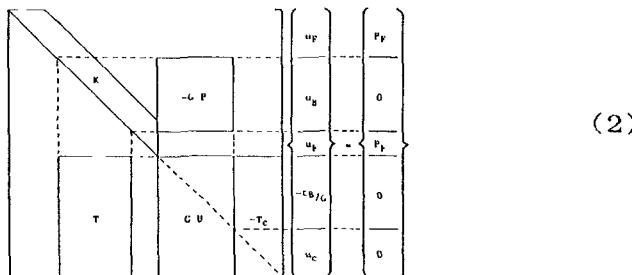
ただし、 $[K]$  は有限要素法による剛性マトリックス、 $[T]$ 、 $[U]$  は境界要素法による共有節点に対する二重層核、および一重層核であり、 $[T_c]$  はき裂上の節点に対する二重層核である。 $[P]$  は表面力を節点力に変換する変換マトリックスである。 $\{u_B\}$  は共有境界上にある節点変位、 $\{u_F\}$  はそれ以外の有限要素領域の節点変位であり、 $\{u_c\}$  は境界要素領域のき裂開口変位である。 $\{P_F\}$  は有限要素に作用する既知節点力である。ここでは、 $[T]$  と  $[U]$  の数値的なオーダーをそろえるため、一重層核にはせん断弾性係数  $G$  を掛けている。このため、 $\{t_B\}$  は  $\{t_B/G\}$  となり、 $[P]$  にも  $G$  が掛かることになる。
