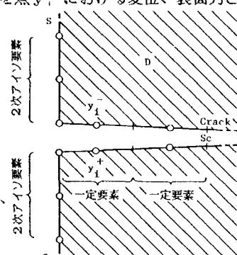
また、き裂上に一定要素を用いると、き裂先端部では開口変位を正確に表現することが出来ない。しかし、一般にき裂先端の開口変位は $\bar{v}$ ( $\bar{v}$ はき裂先端からの距離)なる挙動を示すことが知られている。そこで、き裂先端部要素に対しては $\bar{v}$ なる形状関数を用いて開口変位を表現する。
