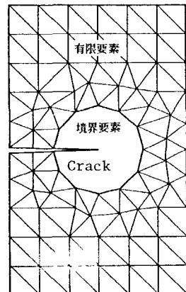
**2.基本設計** 結合解法における基本的な考え方としては、有限要素と境界要素の共有する節点では変位は同一であり、力の伝達は作用反作用の法則により逆向きに等価な力が載荷されるという連続条件によるものとする。
