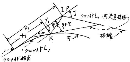
クロソイド  $L_1, L_2$  端の点に接線角をとすれば  $\tau = \frac{1}{2} \cdot \frac{L_1}{R} \dots (5.1)$ , クロソイド終点 K 墓に
