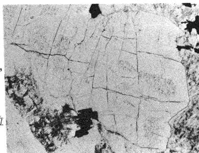
写真-1 北木島花崗岩の顕微鏡写真 長辺方向がrift面、短辺はgrain面 左右端は約25mm
