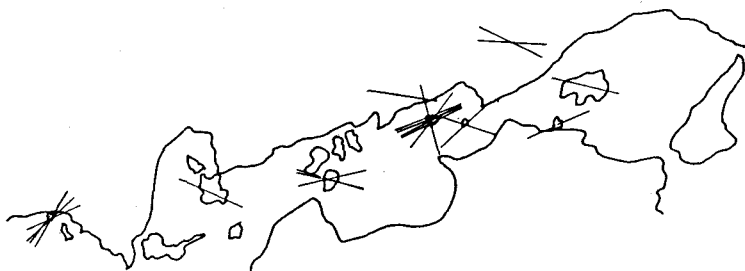
図-1 瀬戸内地域の花崗岩採石場におけるgrain planeの走行
